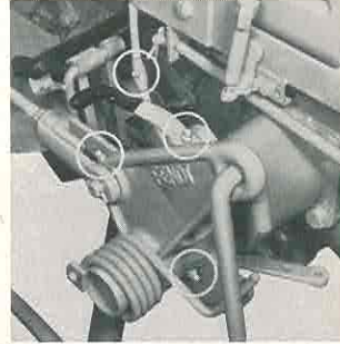
3 Mähauzug, 3 Schmierstellen Bowdenzug zur Mähwerkschaltung
