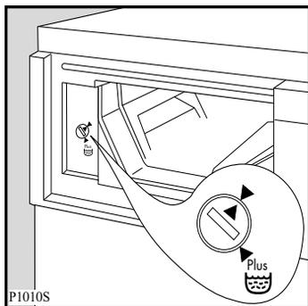
Durch Umstellen des Schalters, mit einer Münze auf das Plus-Symbol, wird in den Normalprogrammen das Wasserniveau der Spülgänge erhöht. Dies ist **zu empfehlen** in Gebieten mit besonders weichem Wasser und für Menschen mit empfindlicher Haut. Der Schalter befindet sich hinter der Waschmittelschublade, auf der linken Seite.
