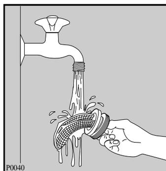
Flusensiebkörper reinigen, einsetzen und wieder fest verschrauben.
