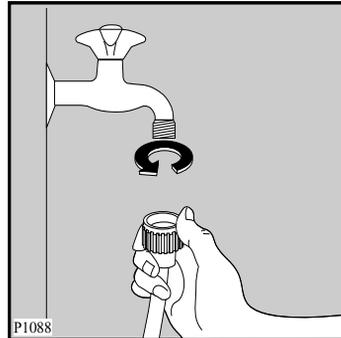
Bei geöffnetem Wasserhahn (unter vollem Leitungsdruck) die Anschlussstelle am Gerät und am Wasserhahn auf Dichtheit prüfen!
