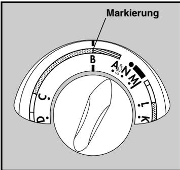
Auf der Skala des Programmwahlschalters, die sich während des Programmablaufs dreht, sind unterschiedlich gekennzeichnete Segmente vorhanden, die den Programmablauf anzeigen. Das Segment, das sich gerade unterhalb der Markierung im Sichtfenster befindet, wird momentan abgearbeitet.
