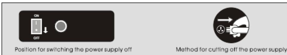
Schematische Darstellung der Schalterstellung
