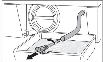
4. Die Waschlauge läuft ab. Falls es erforderlich ist, das Auffanggefäß mehrfach auszuleeren, den Notentleerungsschlauch zwischenzeitlich mit dem Verschlussstopfen verschließen.
