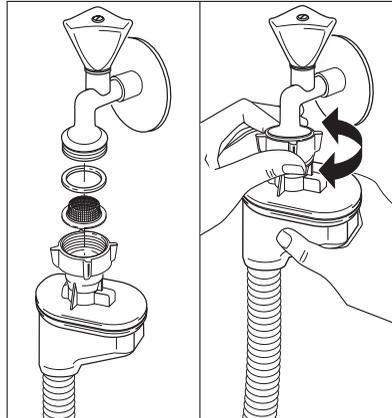
4. Wasserhahn langsam öffnen und prüfen, ob alle Anschlüsse dicht sind.
