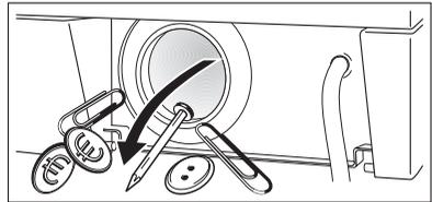
5. Überprüfen, ob sich das Pumpenrad ganz hinten im Pumpengehäuse drehen lässt. (Ruckartiges Drehen des Pumpenrades ist normal.) Lässt sich das Pumpenrad nicht drehen, bitte den Kundendienst verständigen.
