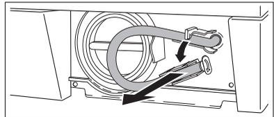
3. Flaches Auffanggefäß unterstellen. Anschließend Verschlussstopfen durch Drehen gegen den Uhrzeigersinn lösen und herausziehen.
