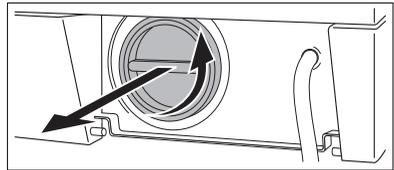
4. Fremdkörper sowie Textilflusen aus Pumpengehäuse und vom Pumpenrad entfernen.
