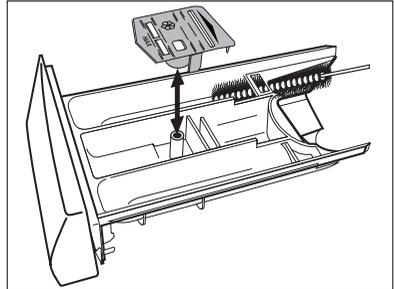
5. Gesamten Einspülbereich des Waschautomaten, besonders auch die Düsen an der Oberseite der Einspülkammer, mit einer Bürste reinigen.
