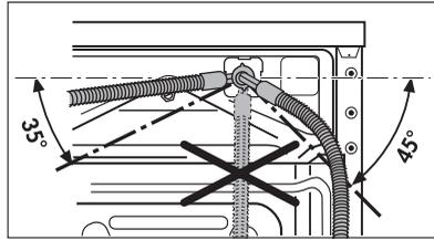
2. Schlauch mit dem geraden Anschluss an einen Wasserhahn mit Schraubgewinde R 3/4 (Zoll) anschließen.
