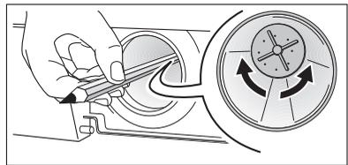
6. Pumpendeckel einsetzen. Stege am Deckel seitlich in die Führungsschlitze einführen und Deckel im Uhrzeigersinn festschrauben.
