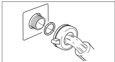
**Achtung!** Den Zulaufschlauch nicht senkrecht nach unten, sondern gemäß Abbildung nach rechts oder links verlegen.
